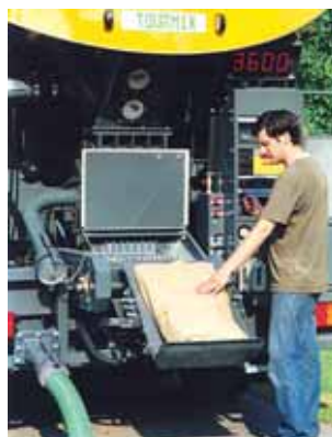
Воронка для загрузки компонентов с устройством для вскрывания мешков
