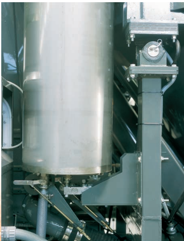
System Buschhoffa do dozowania oleju pastewnego w oparciu o pomiar elektroniczny (bez osłony).
