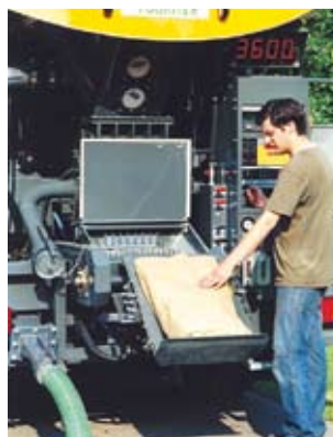
Lejek komponentów z urządzeniem do otwierania worków
