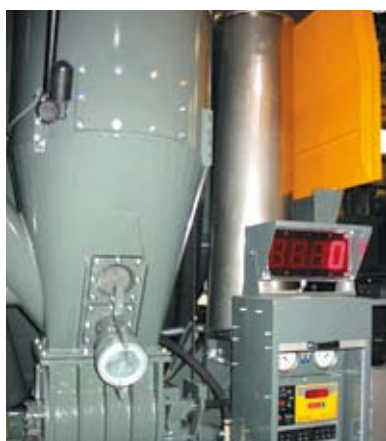
Pojemnik dozownika o pojemności 150 kg
